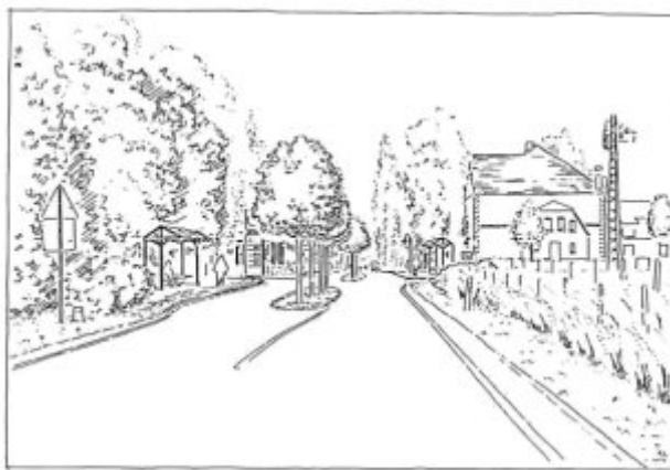
fig. 12 Ingresso settentrionale alla località con salvagente centrale, leggera incurvatura della carreggiata per smorzare la velocità e la nuova pensilina della dell'autobus
