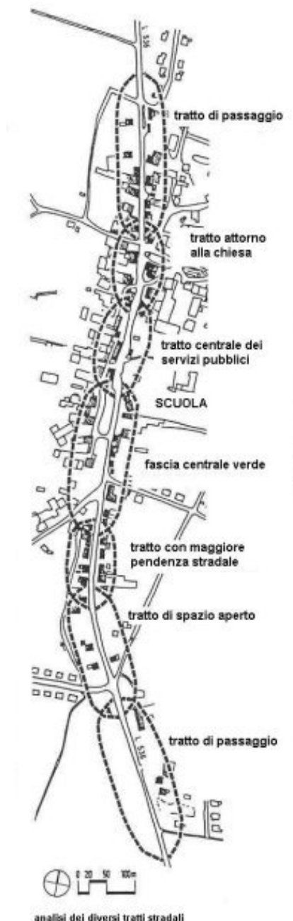
Fig. 2. segmenti dello spazio stradale
